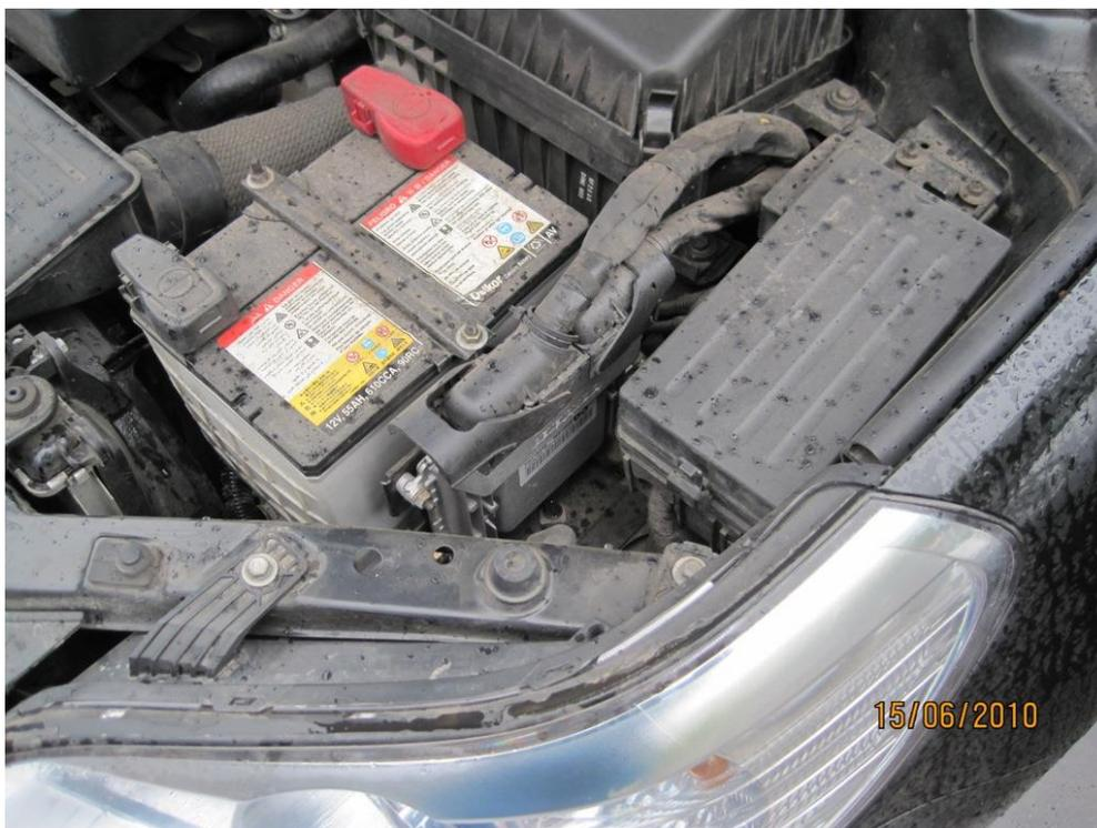
Перед снятием ЭБУ рекомендуется отключить минусовую клемму аккумулятора.
