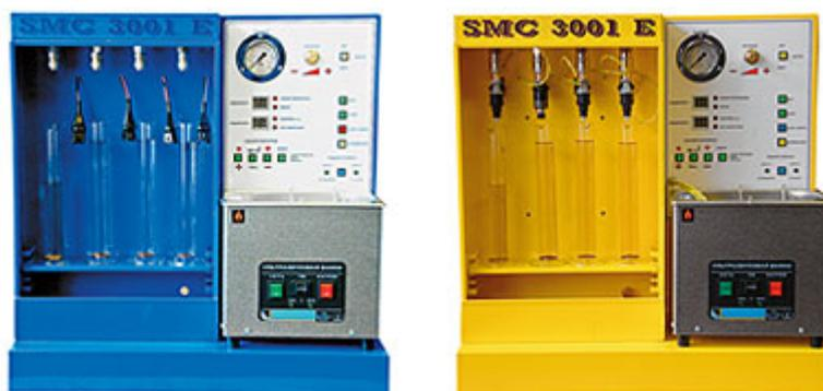
Фото 4. Ультразвуковые установки для проверки и очистки форсунок
