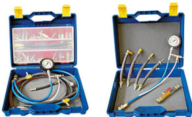
**Фото 1. Диагностические наборы для топливных систем впрыска**
